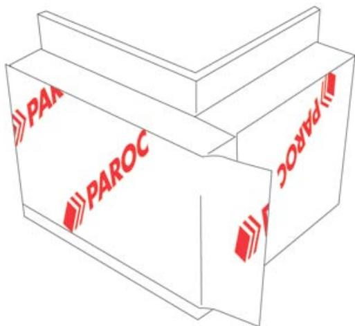
При использовании плит PAROC WPS 3n в качестве ветровой защиты рекомендуется проклеить наружные углы широкой лентой для герметизации углов. Также следует загерметизировать швы между плитами.
