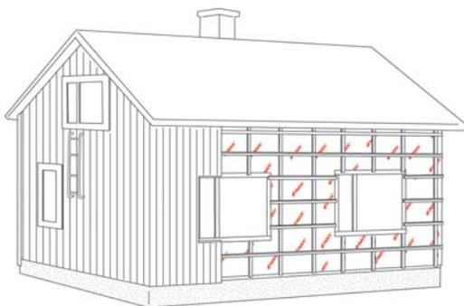
В случае установки вертикальной облицовки следует сначала произвести монтаж вертикальной решетчатой обшивки, после чего наколотить на нее дополнительную горизонтальную решетчатую обшивку.
