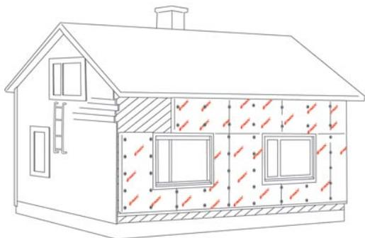
Установите ветрозащитные плиты (PAROC WAS25t или PAROC WPS 3n) с внешней стороны деревянного каркаса таким образом, чтобы они были обращены облицовкой наружу. Произведите укладку плит, соединяя их встык друг с другом. Для предварительного крепления плит рекомендуется использовать гвозди или винты с шайбами (по 5–6 шт. на плиту).
