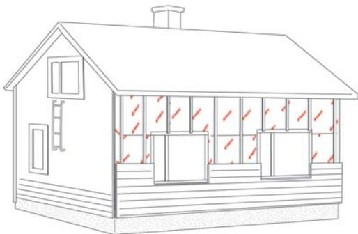
В случае установки горизонтальной облицовки с наружной стороны следует произвести монтаж вертикальной решетчатой обшивки, прибив ее к стене гвоздями, проходящими через распорные элементы.
