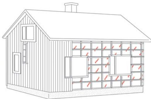
В случае установки вертикальной облицовки следует сначала произвести монтаж вертикальной решетчатой обшивки, после чего наклеить на нее дополнительную горизонтальную решетчатую обшивку.
