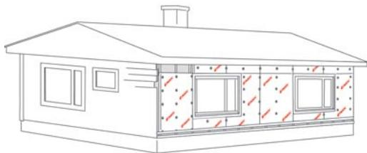
Установите ветрозащитные плиты (PAROC WAS25 или PAROC WPS 3n) с внешней стороны деревянного каркаса таким образом, чтобы они были обращены облицовкой наружу. Произведите укладку плит, соединяя их встык друг с другом. Для предварительного крепления плит рекомендуется использовать гвозди или винты с шайбами (по 5–6 шт. на плиту).
