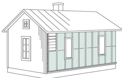
Уложите плиты PAROC eXtra между деревянными каркасами. Рекомендуется использовать целые плиты, тщательно подгоняя их по краям. Загерметизируйте соединения вокруг окон и дверей с использованием уплотнительной ленты. Обеспечьте полное заполнение деревянного каркаса изоляционным материалом.
