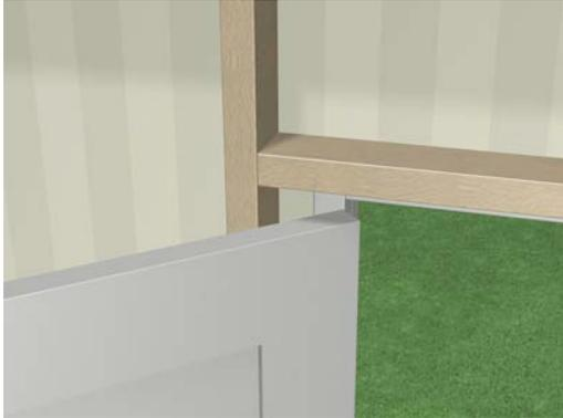
Произведите монтаж обшивки вокруг окон и дверей. Если требуется, чтобы окна или двери открывались на угол более 90°, обшивка должна располагаться несколько дальше от каркаса. Проклейте соединения вокруг окон и дверей уплотнительной лентой.
