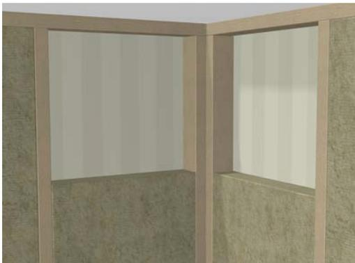
Произведите монтаж стоек на стены, пол и потолок и закрепите стойки по углам. Не забывайте о необходимости изоляции углов. Монтаж вертикальных стоек на стену следует производить с шагом 600 мм.
