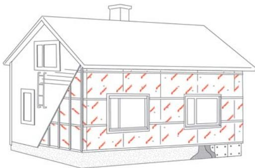
После монтажа всех ветрозащитных плит следует установить вертикальную решетчатую обшивку шагом 600 мм.
