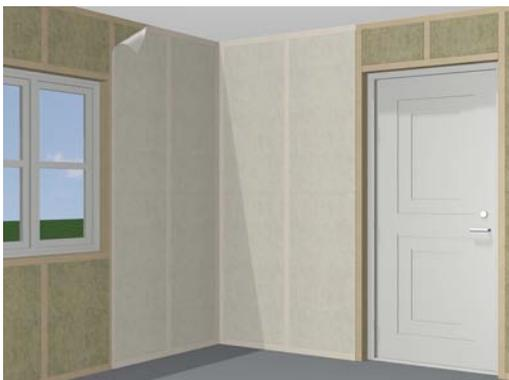
Установить пароизоляцию. Укладку следует производить внахлест с перекрытием не менее 200 мм, а швы следует загерметизировать, проклеив их лентой.
