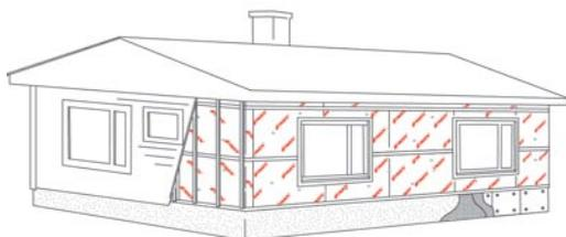
После монтажа всех ветрозащитных плит следует установить вертикальную решетчатую обшивку шагом 600 мм.
