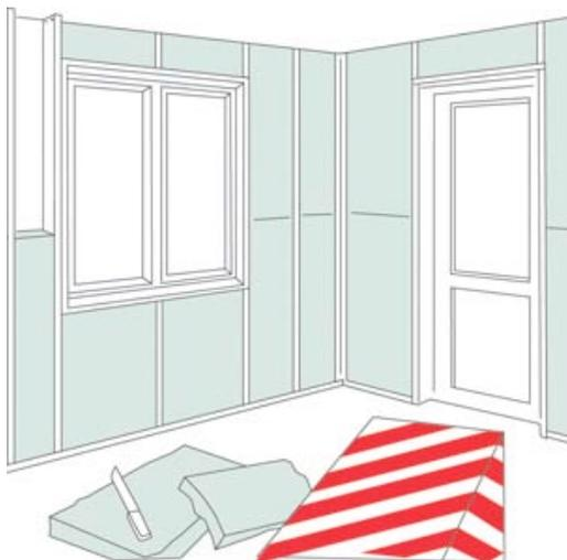
После монтажа внутренней электропроводки следует произвести укладку на каркас плит PAROC eXtra, аккуратно производя их резку с запасом по ширине 2–5 мм.
