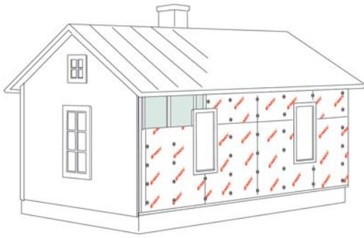
С внешней стороны деревянного каркаса установите ветрозащитную плиту таким образом, чтобы она была обращена покрытием наружу. Произведите укладку плит, соединяя их встык друг с другом. Для предварительного крепления плит рекомендуется использовать гвозди или винты с шайбами (по 5–6 шт. на плиту).
