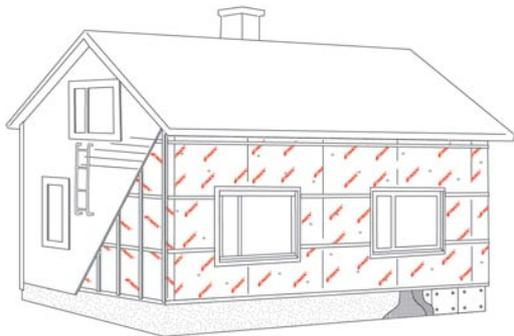
После установки всех ветрозащитных плит на стену следует прижать их к распорным элементам, располагающимся на расстоянии около 600 мм (как на деревянном каркасе). Верхний ряд распорных элементов не должен находиться ниже линии соединения стены и кровли более чем на 200 мм.
