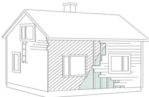
Снимите старый фасад и ветрозащитную плиту. Загерметизируйте имеющиеся щели и произведите ремонт конструкций, поврежденных в результате воздействия влаги или плесени.
