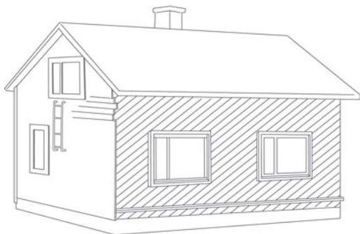
Для обеспечения плотного крепления фасадных панелей следует установить и приколлотить гвоздями горизонтальные стойки в верхней части и в основании фасада, а также произвести монтаж обшивки вокруг окон и дверей.
