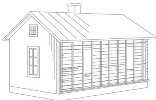
С помощью подвижных крепежных элементов установите опорные стойки на межцентровом расстоянии друг от друга 600 мм.
