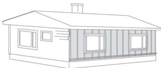
Для обеспечения плотного крепления фасадных панелей следует установить и приколотить гвоздями горизонтальные стойки в верхней части и в основании каркаса, а также произвести монтаж обшивки вокруг окон и дверей.
